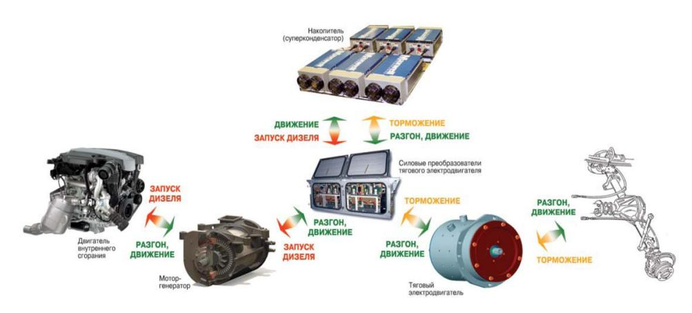
Зелеными стрелками показано направление потоков мошности при разгоне и движении транспорта, желтым цветом – при торможении, красным – при запуске ДВС от накопителя энергии при помощи мотор-генератора.
